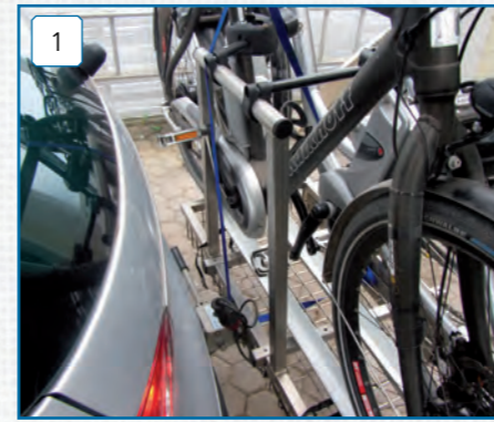
Montage - Rohrbügel + Rohrtraversen mit Aluradschienen
