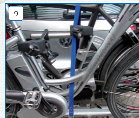
Sicherung der Räder/Rohrbügel/Hecktransporter mit Spanngurt
